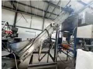
Przenośnik taśmowy - taśma podawcza firmy Pro-Vega, k=symbol indeksu A 40
