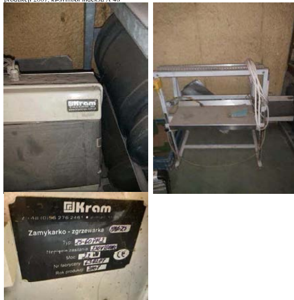
Zamykarko - zgrzewarka firmy Kram Max-Zs, typ ZS-60 PN2, Moc 2,2 kW, nr fabryczny 630207, rok produkcji 2007, k→symbol indeksu A 48
